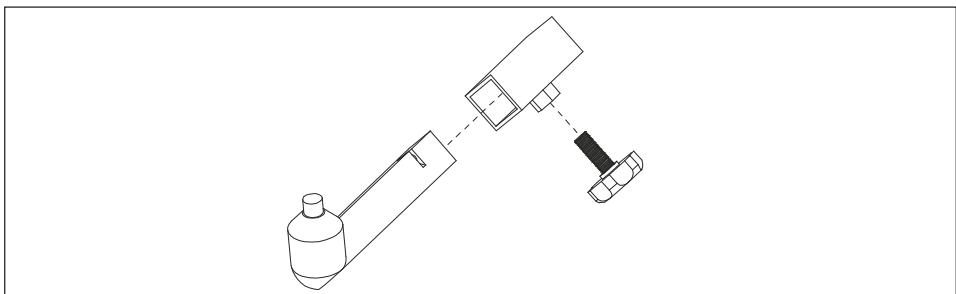
Вставьте передний переходник изнутри в соответствующие гнезда и слегка затяните болтом со звездообразной головкой. Мотоциклетный подъемник рассчитан на ширину вилки от 200 до 270 мм.
