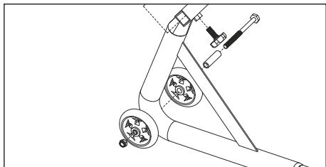
Następnie umieścić w kółkach tuleje dystansowe. Przyłożyć kółka z prawej i lewej strony otworu na oś. Od zewnętrznej strony wprowadzić sworzeń przez kółka i otwór na oś, po czym zabezpieczyć nakrętką (potrzebne są klucze o rozmiarze 13 i 14 mm). Założyć zaślepkę na nakrętkę. Powtórzyć powyższe czynności z drugiej strony.
