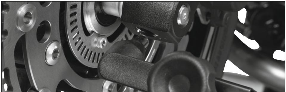
Den Motorradheber mit den Aufnahmen für unten offene Gabelstandrohre auf die Breite der Vorderradgabel einstellen. Dazu hält eine zweite Person den Lenker in gerader Position. Die Aufnahmen von vorne unter die Gabelstandrohre des Motorrades heranführen. Die Aufnahmen so verschieben, dass diese komplett unter beide Gabelstandrohre passen und die Adapter in die Öffnung/ Bohrung der Gabelstandrohre passen.
