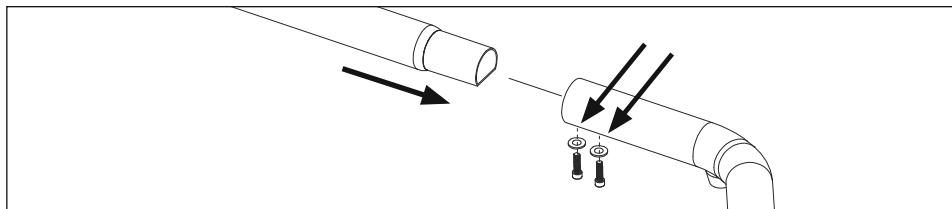
Avant toute utilisation, vous devez commencer par monter la béquille d'atelier. Pour cela, glissez les deux équerres de levage dans le tube de raccordement et vissez chaque côté à l'aide de deux vis à six pans creux (taille de clé : 4) et rondelles plates par le dessous.
