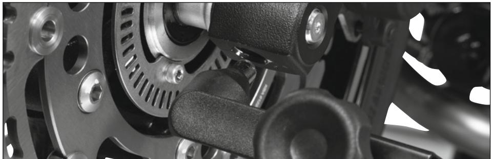
Stel de paddockstand met de steunpunten voor vorkpoten met een open onderkant in op de breedte van de voorvork. Daarbij moet een helper het stuur rechtop houden. Leid de steunpunten van voren onder de vorkpoten van de motor. Schuif de steunpunten zo, dat deze volledig onder de beide vorkpoten passen en de adapters in de opening/boring van de vorkpoten passen.
