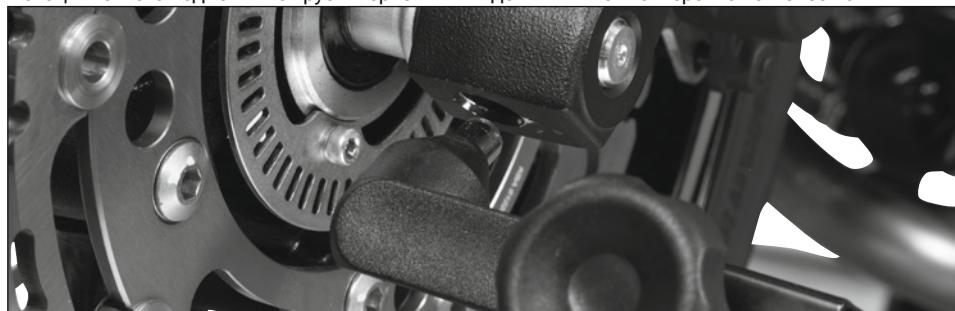
Отрегулируйте мотоциклетный подъемник с опорами под открытые внизу трубы перьев вилки по ширине вилки переднего колеса. При этом помощник держит руль ровно.
