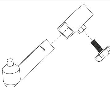
Od wewnętrznej strony wsunąć adaptery czołowe w odpowiednie otwory mocujące i lekko dokręcić śrubę z pokrętłem gwiazdowym. Podnośnik motocyklowy może być używany do widelców o szerokości ok. 200 do 270 mm.
