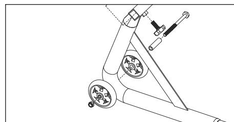
Steek hierna de afstandsbussen in de wielen. De wielen worden elk links en rechts naast de assteun geplaatst. Steek nu de bout van buiten door de wielen en de assteunen en trek met de moer aan (je hebt hiervoor de sleutelmatten 13 en 14 nodig). Plaats hierna de afdekking op de moer. Herhaal de beschreven stappen aan de andere kant.
