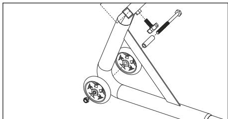
A continuación, introduzca los casquillos distanciadores en las ruedas. Coloque las ruedas a izquierda y derecha junto al alojamiento del eje. Ahora introduzca el perno desde el lado exterior por las ruedas y el alojamiento del eje y apriételo con la tuerca (se necesitan llaves de tamaño 13 y 14 mm). A continuación, coloque la tapa sobre la tuerca. Repita en el otro lado los pasos descritos.
