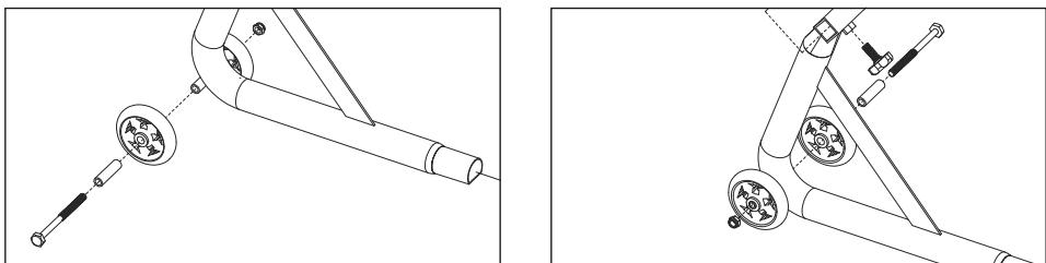
Затем вставьте распорные втулки в колеса. Колеса размещаются, соответственно, с левой и правой стороны от креплений оси. После этого вставьте болты через колеса и крепления оси с наружной стороны и затяните гайками (для этого требуются ключи на 13 и 14 мм). Затем наденьте на гайку колпачок. Повторите описанные действия на другой стороне.
