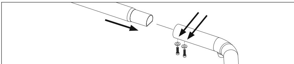
Der Motorradheber muss vor dem Verwenden zunächst montiert werden. Dazu werden die beiden Aufbockwinkel in das Verbindungsrohr geschoben und von unten auf jeder Seite mit zwei Innensechskantschrauben (Schlüsselgröße 4) und Unterlegscheiben verschraubt.
