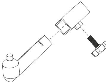
Steek de frontadapter van binnen in de dienovereenkomstige houders en trek met de stervormige knopschroef licht aan. De paddockstand is geschikt voor een vorkbreedte van ca. 200 tot 270 mm.
