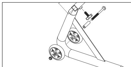
Insérez ensuite les douilles d'espacement dans les roulettes. Les roulettes sont placées à droite et à gauche du support d'axe. Faites passer ensuite les boulons à travers les roulettes et le support
