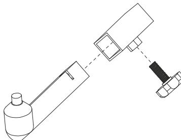
Enfoncez l'adaptateur avant par l'intérieur dans les supports correspondants, puis serrez légèrement avec la vis à poignée étoile. La béquille d'atelier convient pour une largeur de fourche comprise entre 200 et 270 mm.
