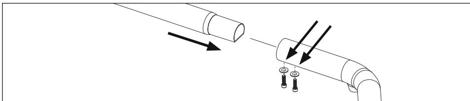
Antes del uso es necesario montar el caballete. Para ello, introduzca los dos ángulos del caballete en el tubo de unión y atorníllélos por abajo en cada lado con dos tornillos Allen (tamaño de llave 4) y sendas arandelas.
