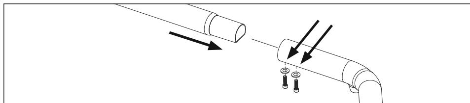
De paddockstand moet voor het gebruik eerst worden gemonteerd. Hiervoor worden de twee opboekhoeken in de verbindingsbuis geschoven en van onder aan elke kant met twee binnenzeskantschroeven (sleutelmaat 4) en vulringen vastgeschoefd.
