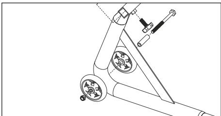
Insérez ensuite les douilles d'espacement dans les roulettes. Les roulettes sont placées à droite et à gauche du support d'axe. Faites passer ensuite les boulons à travers les roulettes et le support d'axe par l'extérieur, puis serrez à l'aide de l'écrou (tailles de clés nécessaires : 13 et 14 mm). Placez ensuite le capuchon sur l'écrou. Répétez les étapes indiquées de l'autre côté.
