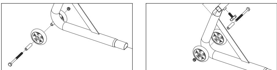
Затем вставьте распорные втулки в колеса. Колеса размещаются, соответственно, с левой и правой стороны от креплений оси. После этого вставьте болты через колеса и крепления оси с наружной стороны и затяните гайками (для этого требуются ключи на 13 и 14 мм). Затем наденьте на гайку колпачок. Повторите описанные действия на другой стороне.
