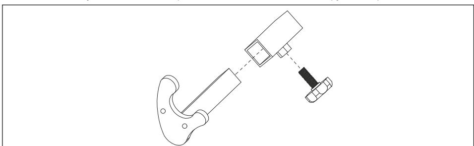
Затем вставьте подходящий для конкретного мотоцикла переходник в соответствующие гнезда и слегка затяните болтом со звездообразной головкой. Мотоциклетный подъемник рассчитан на ширину опор от 270 до 370 мм.
