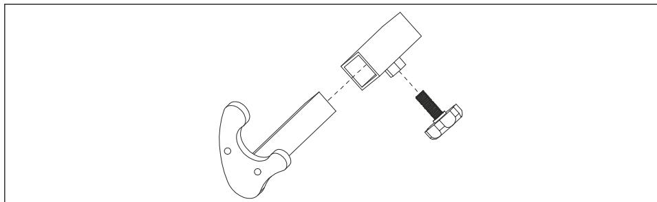
Następnie od wewnętrznej strony wsunąć w uchwyty adapter odpowiedni dla danego motocykla i lekko dokręcić śrubę z pokrętłem gwiaździstym. Podnośnik motocyklowy może być używany do uchwytów o szerokości ok. 270 do 370 mm.
