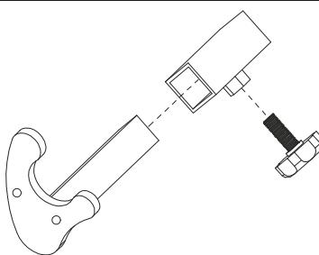
Steek daarna de voor de betreffende motor geschikte adapter aan de binnenkant in de bijbehorende bevestigingspunten en trek licht met de stervormige knopschroef aan. De paddockstand is geschikt voor een steunpuntbreedte van ca. 270 tot 370 mm.
