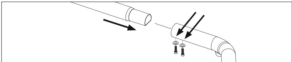
Перед использованием мотоциклетный подъемник необходимо сначала смонтировать. Для этого вставьте оба опорных уголка в соединительную трубу и привинтите снизу с каждой стороны двумя винтами с внутренним шестигранником (размер ключа 4) и с подкладными шайбами.
