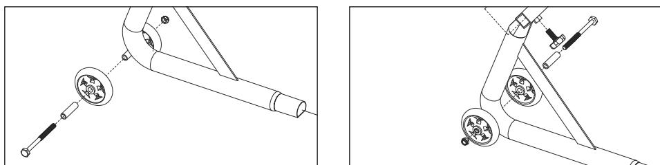
Następnie umieścić w kółkach tuleje dystansowe. Przyłożyć kółka z prawej i lewej strony otworu na oś. Od zewnętrznej strony wprowadzić sworzeńki i otwór na oś, po czym zabezpieczyć nakrętką (potrzebne są klucze o rozmiarze 13 i 14 mm). Założyć zaślepkę na nakrętkę. Powtórzyć powyższe czynności z drugiej strony.
