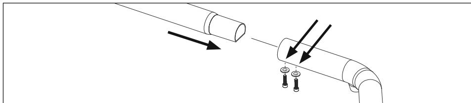
Prima dell'uso, l'alzamoto deve essere innanzitutto montato. A questo proposito, i due angolari di sollevamento vengono spinti nel tubo di collegamento e avvitati dal basso su ogni lato con due viti a esagono incassato (chiave da 4) e rondelle.
