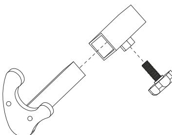
Danach den für das jeweilige Motorrad geeigneten Adapter innen in die entsprechenden Aufnahmen stecken und leicht mit der Sterngriffschraube festziehen. Der Motorradheber ist für eine Aufnahmehöhe von ca. 270 bis 370 mm geeignet.
