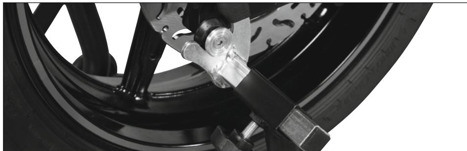
Per prima cosa controllare se sul braccio oscillante dell'alzamoto Rothewald sono presenti nottolini adatti avvitati in modo sicuro. Eventualmente è necessario applicare prima dei nottolini da acquistare separatamente sugli appositi filetti interni del braccio oscillante.
