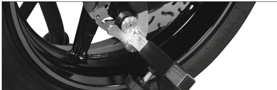
Zunächst prüfen, ob an der Schwinge für den Rothewald Motorradheber geeignete, sicher verschraubte Prismabuchsen vorhanden sind. Ggf. müssen separat zu erwerbende Prismabuchsen an den dafür vorgesehenen Innengewinden an der Schwinge angebracht werden.
