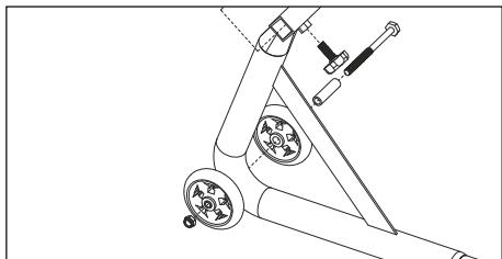
Anschließend die Distanzhülsen in die Räder stecken. Die Räder werden jeweils links und rechts neben der Achsaufnahme platziert. Jetzt den Bolzen von außen durch die Räder sowie die Achsaufnahme führen und mit der Mutter festziehen (es werden die Schlüsselgrößen 13 und 14 mm benötigt). Anschließend die Abdeckkappe auf die Mutter aufstecken. Auf der anderen Seite die gezeigten Schritte wiederholen.
