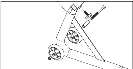
Inserire poi le bussole distanziatrici nelle ruote. Le ruote vengono posizionate a sinistra e a destra, accanto al supporto asse. Dall'esterno, far ora passare il bullone attraverso le ruote e il supporto asse e serrarlo con il dado (sono necessarie chiavi da 13 e da 14 mm). Infilare quindi il cappuccio sul dado. Ripetere le operazioni descritte sull'altro lato.
