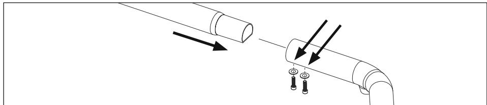
Antes del uso es necesario montar el caballete. Para ello, introduzca los dos ángulos del caballete en el tubo de unión y atorníllelos por abajo en cada lado con dos tornillos Allen (tamaño de llave 4) y sendas arandelas.
