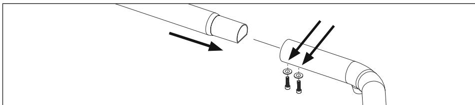
De paddockstand moet voor het gebruik eerst worden gemonteerd. Hiervoor worden de twee opboekhoeken in de verbindingsbuis geschoven en van onder aan elke kant met twee binnenzeskantschroeven (sleutelmaat 4) en vulringen vastgeschroefd.
