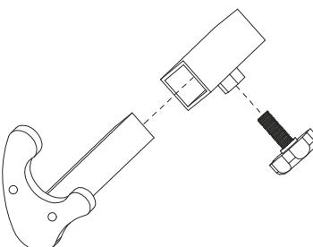
Enfoncez ensuite l'adaptateur adéquat pour votre moto à l'intérieur des supports correspondants, puis serrez légèrement avec la vis à poignée étoile. La béquille d'atelier convient pour une largeur de support comprise entre 270 et 370 mm.
