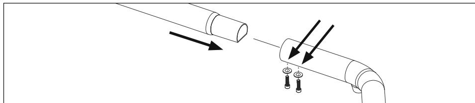
Przed użyciem podnośnika motocyklowego należy najpierw go zmontować. W tym celu wsunąć obydwa ramiona podnośnika w rurę łączącą i z obydwu stron zabezpieczyć od dołu dwoma śrubami imbusowymi (klucz 4 mm), używając również podkładek.
