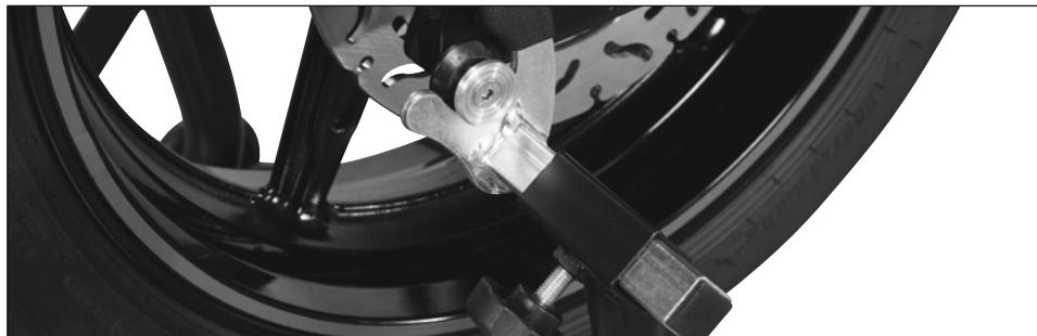
В первую очередь убедитесь, что на маятниковой вилке имеются подходящие для мотоциклетного подъемника Rothewald, надежно прикрученные призматические втулки. В противном случае установите отдельно приобретаемые призматические втулки в специально предназначенные для этого внутренние резьбы на маятниковой вилке.
