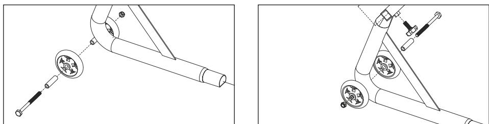
A continuación, introduzca los casquillos distanciadores en las ruedas. Coloque las ruedas a izquierda y derecha junto al alojamiento del eje. Ahora introduzca el perno desde el lado exterior por las ruedas y el alojamiento del eje y apriételo con la tuerca (se necesitan llaves de tamaño 13 y 14 mm). A continuación, coloque la tapa sobre la tuerca. Repita en el otro lado los pasos descritos.
