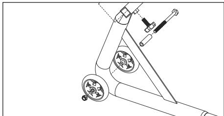
Steek hierna de afstandsbussen in de wielen. De wielen worden elk links en rechts naast de assteun geplaatst. Steek nu de bout van buiten door de wielen en de assteunen en trek met de moer aan (je hebt hiervoor de sleutelmaten 13 en 14 nodig). Plaats hierna de afdekking op de moer. Herhaal de beschreven stappen aan de andere kant.
