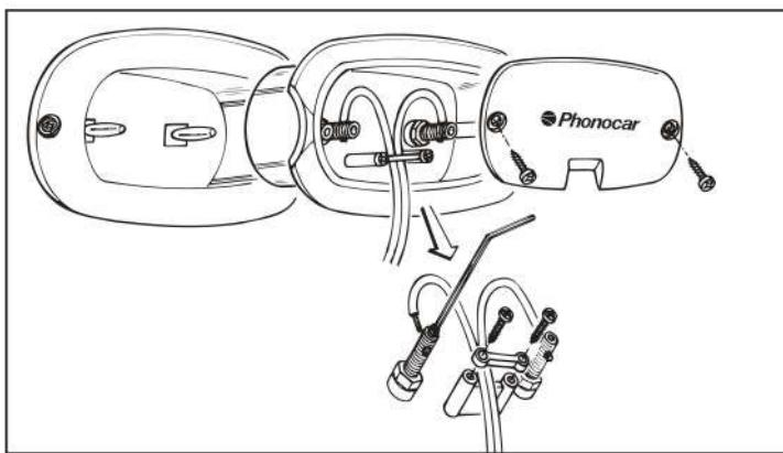
**I** - Effettuare il collegamento elettrico ai morsetti, serrando dolcemente con la chiave fornita in dotazione. Per proteggere le connessioni, bloccare il cavo tramite il morsetto "ferma-cavo".
