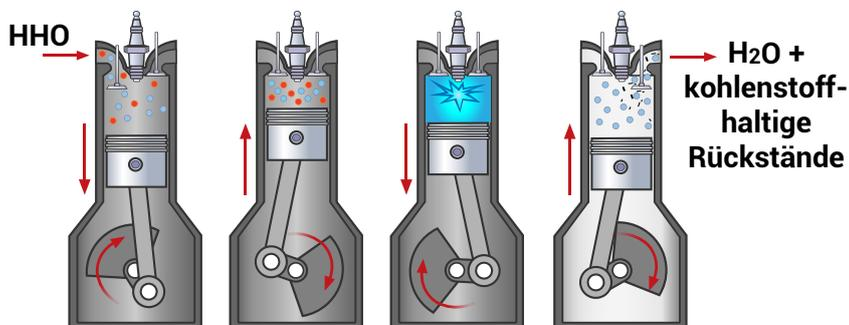
Hierdurch wird der Prozess der **Entkokung** eingeleitet und löst die abgelagerten Verbrennungsrückstände an den Kolben, Ventilen, Injektoren und allgemein an den Bauteilen, die sich zwischen Brennraum und Abgaskanal befinden, auf.
